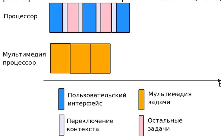
Такое разделение можно назвать "гетерогенной" многоядерной архитектурой, так как на самом деле процессор состоит из нескольких различных ядер, отвечающих за конкретную
