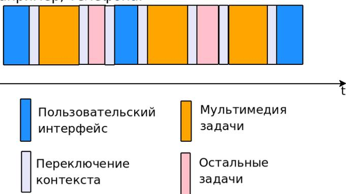
Из рисунка видно, что с одной стороны процессору довольно часто приходится переключаться между задачами различных типов, которые в свою очередь можно делать параллельно. Так, компания Texas Instruments предложила линейку процессоров OMAP (Open Multimedia Application Platform). Данный процессор на самом деле представляет из себя несколько процессоров, каждый из которых отвечает за определенную функциональность, распараллеливая таким образом независимые задачи (см. рисунок).
