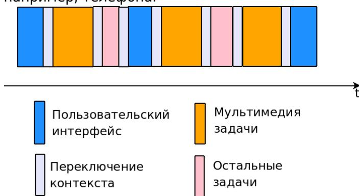
Из рисунка видно, что с одной стороны процессору довольно часто приходится преключаться между задачами различных типов, которые в свою очередь можно делать параллельно. Так, компания Texas Instruments предложила линейку процессоров OMAP(Open Multimedia Application Platform). Данный процессор на самом деле представляет из себя несколько процессоров, каждый из которых отвечает за определенную функциональность, распараллеливая таким образом независящие задачи (см. рисунок).
