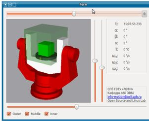
Существует класс испытательных стендов для исследования характеристик высокоточных гироскопов, применяемых в навигации. Обучно такие стенды состоят из поворотного стола, на котором закрепляется гироскоп и термокамеры. Поворотный стол имеет возможность очень точно вращать испытуемый гироскоп по двум, трем и более измерениям одновременно, а термокамера менять температуру окружающей гироскоп среды.
