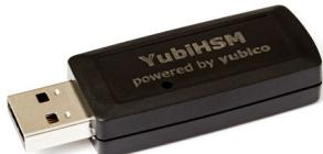
HSM (Hardware Security Module) – это небольшое устройство которое специально спроектировано для хранения информации о закрытых ключах и предоставления доступа к этой информации. Обычно это устройство, выглядит, как USB-Stick.
